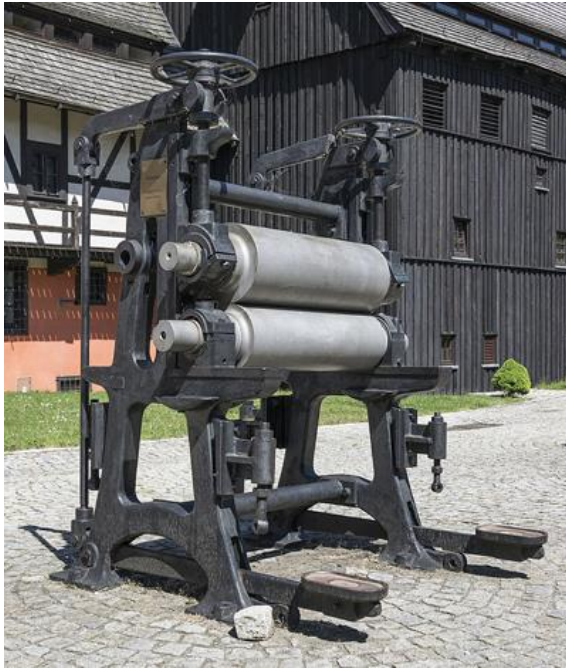
Fot. 5.1.2. Kalander z XVII wieku przeznaczony do gładzenia wysuszonego papieru czerpanego (Muzeum Papiernictwa w Dusznikach Zdroju)
