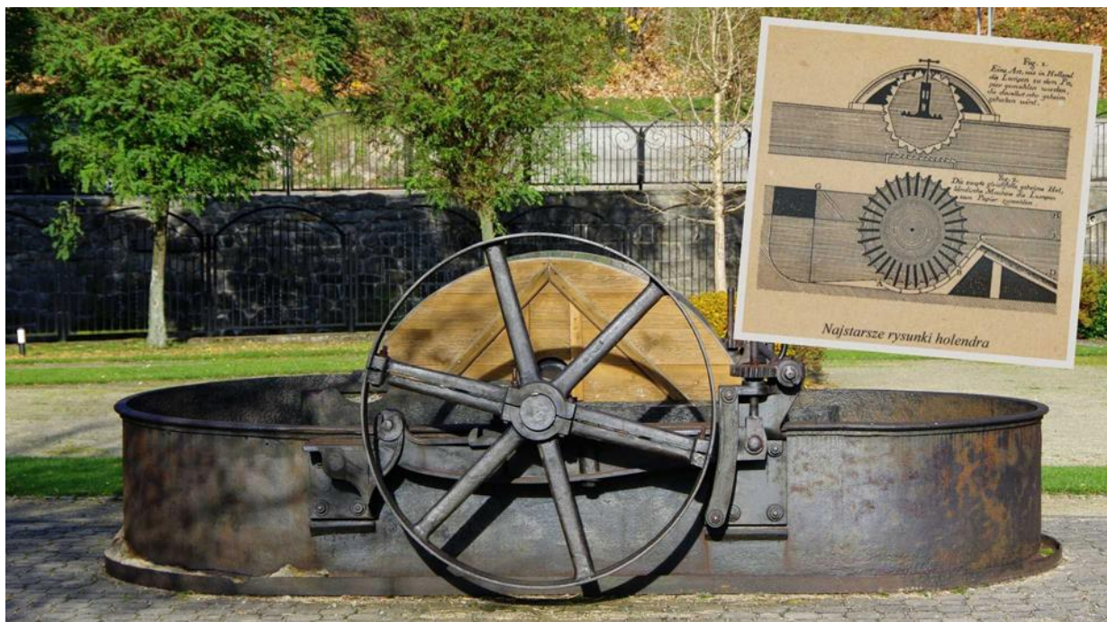
Fot. 5.1.4. Holender ze zbiorów Muzeum Papiernictwa w Dusznikach Zdroju. Rysunki wyjaśniają konstrukcję, położenie zespołów noży i zasadę działania
