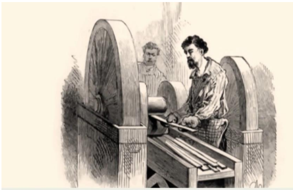
Rys. 1.4.3. Walcowanie lub młotkowanie cany do odpowiednich rozmiarów, źródło [1.1]
