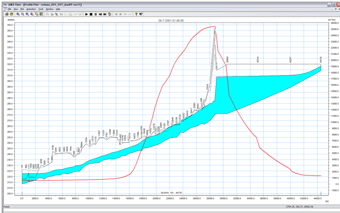
III. 9. Profil des Wasserspiegels und der Durchflüsse für eines der Katastrophenszenarien des Damms am Staubecken Świnna Poręba (Moment des maximalen Abflusses aus dem Profil des Lochs).
