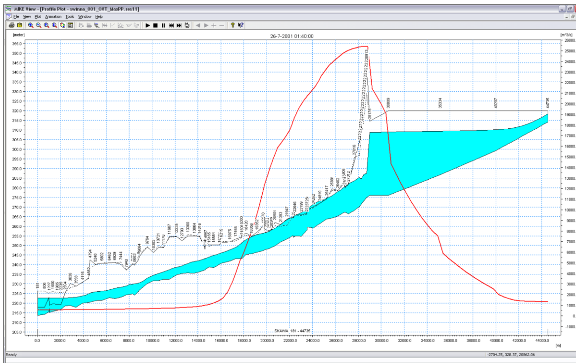
Rys. 9. Profil zwierciadła wody i przepływów dla jednego ze scenariuszy katastrofy zapory zbiornika Świnna Poręba (moment maksymalnego odpływu z profilu wyrwy).
