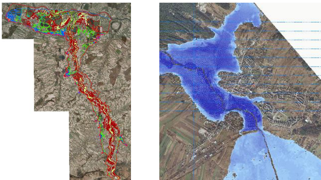
Rys. 10. Zasięgi stref zalewowych z modelu 1D opracowane dla doliny poniżej zapory w Świnnej Porębie (po lewej) oraz fragment animacji z modelu 2D, prezentującego rozprzestrzenianie się fali powodziowej w dolinie poniżej zapory w Chańczy.
